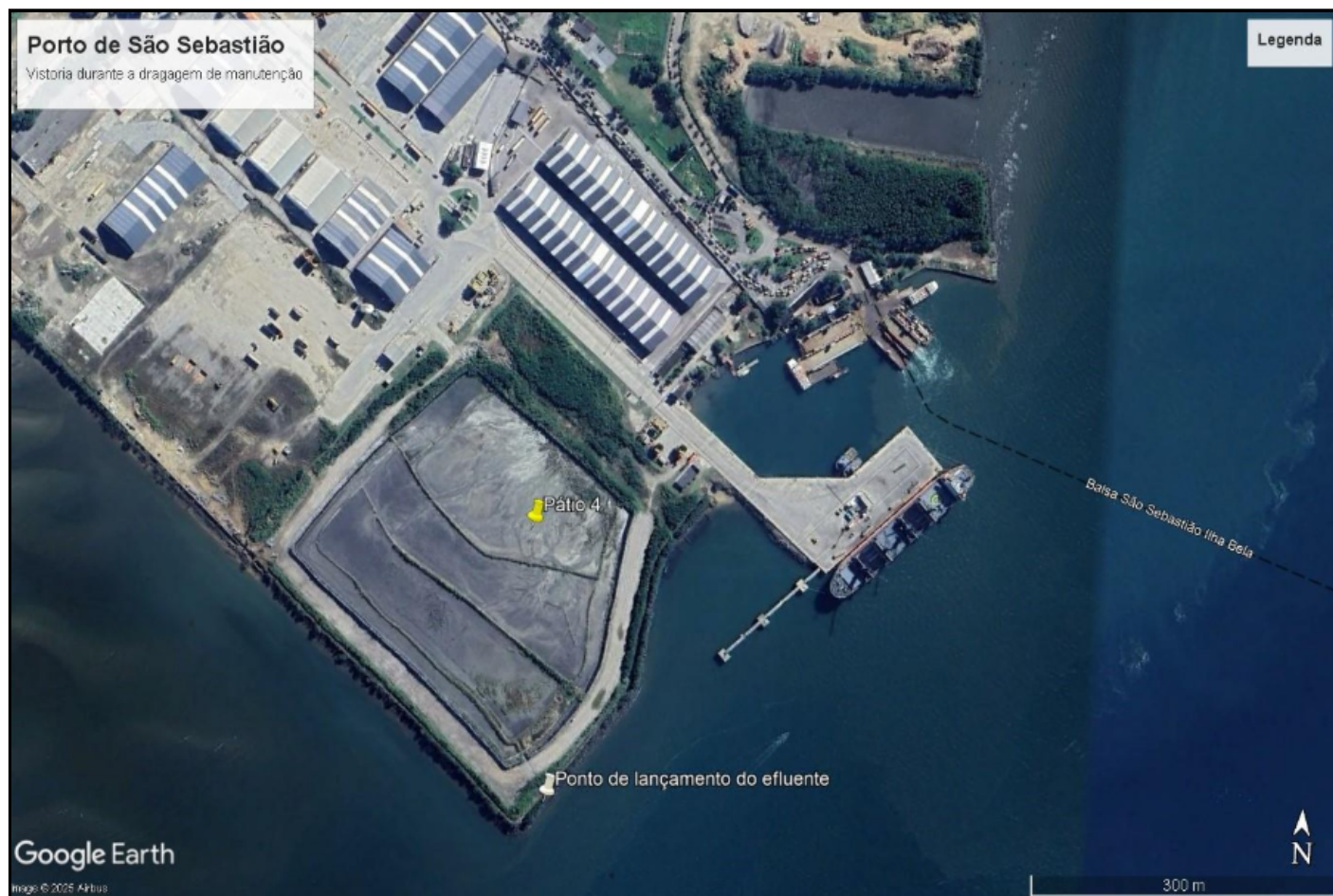
Figura 1: Imagem do Porto, com destaque para o Pátio 4, onde o material é lançado em terra e para o ponto de lançamento do efluente após decantação dos sedimentos no sistema de chicanas.
