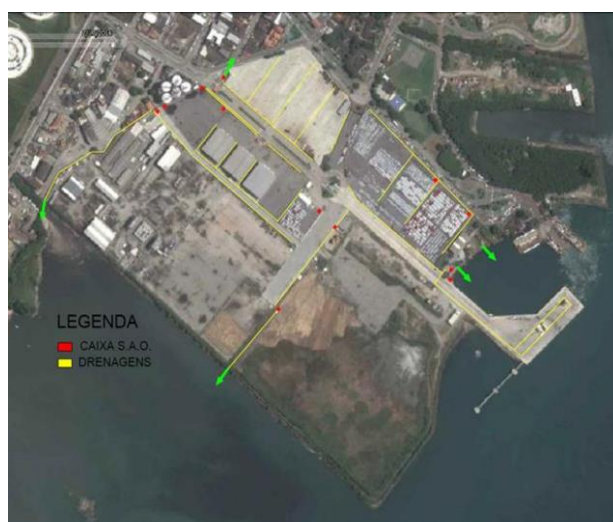
Figura 44 Sistema de drenagem de águas pluviais das instalações do Porto Público de São Sebastião. FONTE: PEI.
