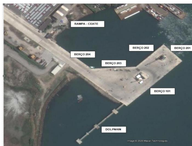
Figura 8 Cais e instalações de atracação – Berço de Atracação - o Cais é formado por cinco berços de acostagem. Fonte: PEI.
